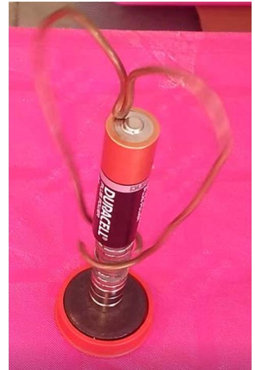
**EXPONER LA SOLUCIÓN:** Un motor eléctrico transforma la energía eléctrica en energía mecánica (en movimiento). Por el cable de cobre circulará una corriente eléctrica (de la pila). La influencia del campo magnético de los imanes hace que se mueva el corazón.
